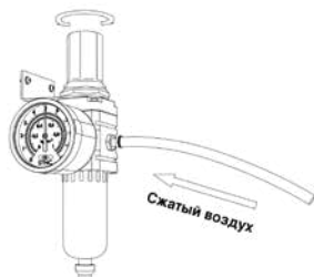
Рис. 8.6. Фильтр-регулятор аппарата воздушно-плазменной резки.
