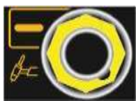
P - Отрицательный выходной зажим (-)
