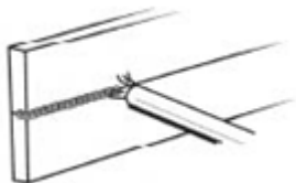
Рисунок 13. Горизонтальное положение при сварке
