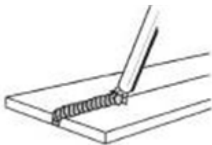
Рисунок 12. Нижнее положение при сварке
